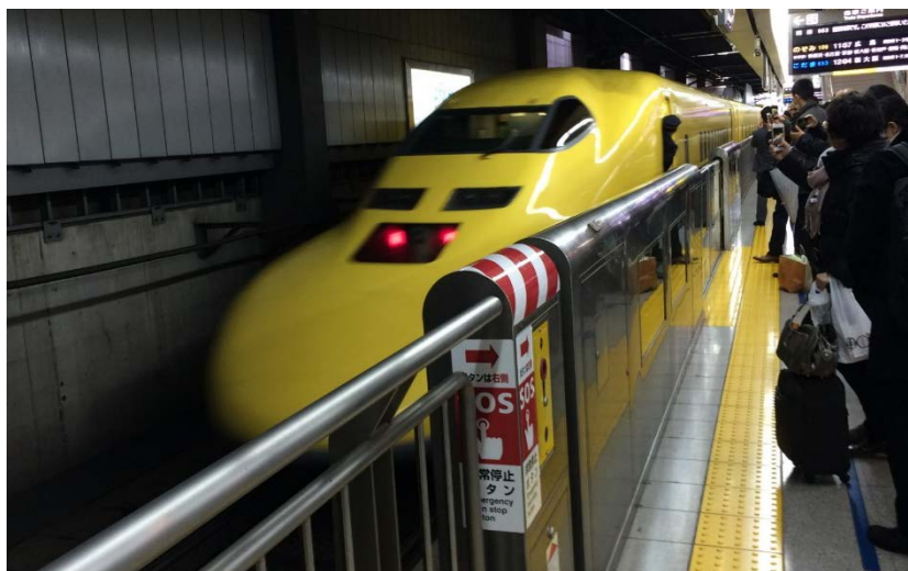
新幹線電気軌道総合試験車 (通称:ドクターイエロー)923形
